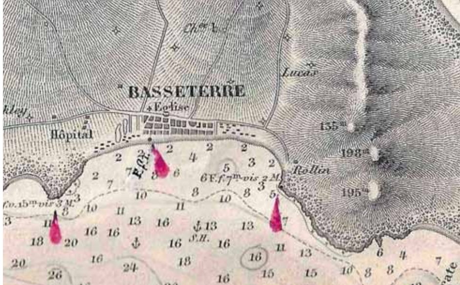
10. Kaart in zwart met de steunkleur Magenta (vlammetjes). Het reliëf van het berglandschap is volledig in schrapjes uitgewerkt. NB De kaart is kennelijk gebruikt als bronmateriaal voor een kleinschaliger kaart; in potlood zijn sporen van een generalisatie te zien. (FR 3407, Antilles, St. Christophe, Nièves, St. Eustache et Saba, 1:70.000, Uitgave 1875, Druk 1949).
