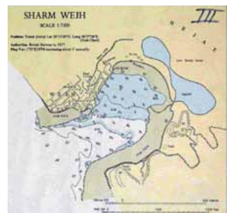
8. Plankaartje waarop ondiep water tot de 5-meterlijn vol blauw en met een bies in dezelfde kleur op de 10-meterlijn. De droogvallingen zijn in een combinatiekleur van landtint en 'waterblauw'. Verder een bescheiden topografie met diverse kenbare punten. (BA 3043, Egypt, Harbours and anchorages in the Red Sea, 1:7.500, Uitgave 1971)
