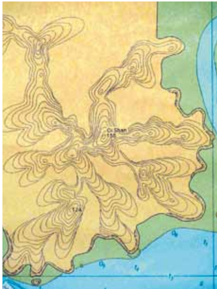
26. Een opvallende presentatie van reliëf, door middel van vereenvoudigde vormlijnen in een licht geaccidenteerd terrein. (BA 2400, China; Dong Hai; Minjiang Kou Anchorage and Approaches, 1:15.000, Uitgave 1982)
