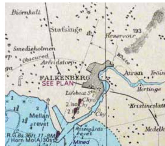
17. Zweedse kust, rijkelijk 'bestrooid' met niet te identificeren huisjes. Daartussen zijn kenbare punten te vinden, zoals schoorstenen (Chy), een molen, een windmotor en kerktorens. De kustlijn in het zuidoosten is niet nauwkeurig bepaald. (BA 3667, Sweden, West Coast; Nidingen to Tylo, 1:100.000, Uitgave 1907, Editie 1993)
