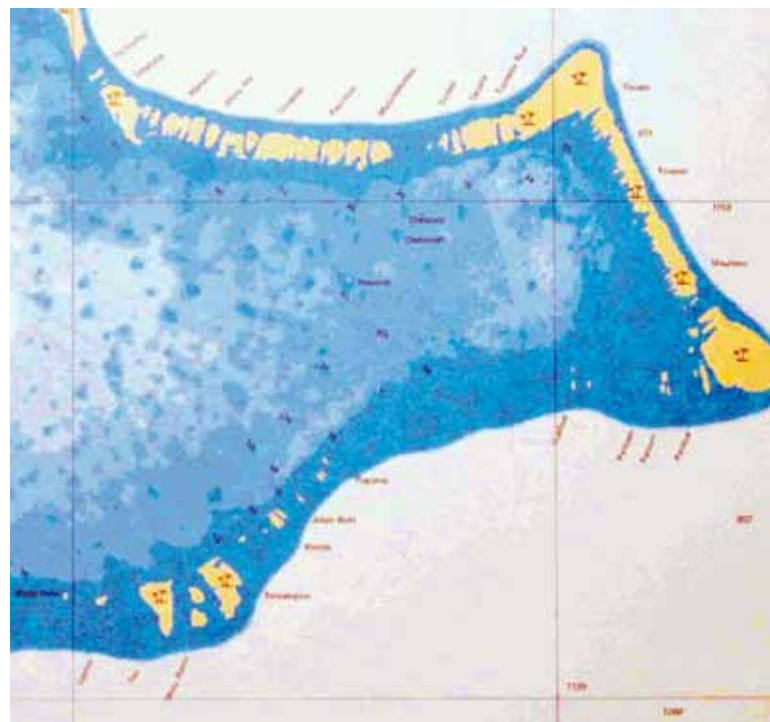
7. Gebruik van een fel blauwe kleur, in vier tinten. De droogvallingskleur (zuidzijde atol) is een combinatie van vol blauw met de lichte landtint en is moeilijk te onderscheiden. (FR 7373, Archipel de Tuamotu; Rangiroa, 1:80.000, Uitgave 1997)
