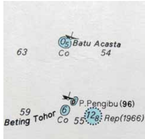
25. Hoe klein ook de ondiepte: vroeg of laat loopt er een schip op... Een minuscuul eilandje (met toch een hoogte van 96m) en een ondiepte, ca 4,5 mijl uit elkaar (en ook nog een gerapporteerde ondiepte van 12,8m) in een verder lege zee. Op beide een "zichtbaar wrak", dat wil zeggen dat een deel van het wrak boven water uit steekt. Niet zozeer als gevaar voor de scheepvaart in de kaart gezet, maar omdat het in deze (lege) omgeving als kenbaar punt kan dienen. (Meestal liggen wrakken volledig onder water en worden dan anders gekarteerd). (BA 1311, South China Sea, Singapore Strait to Pulau-Pulau Subi Besar, 1:500.000, uitgave 1991)
